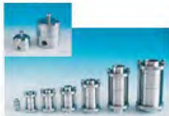
**Компенсаторы пульсаций:** возвратно-поступательное движение поршня вызывает пульсации: во время каждого хода жидкость, находящаяся в приеме насоса и в нагнетательных линиях, с нуля ускоряется до максимальной скорости, а затем снова замедляется до нуля. Компенсаторы пульсации - это приспособления, предназначенные для уменьшения высоких и недопустимых колебаний давления, или для достижения прямолинейности потока.
